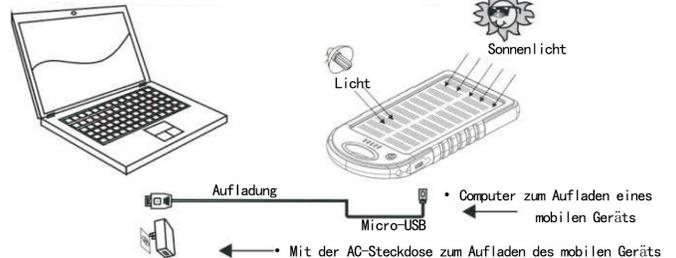
Der Akku kann auch über das Solarpanel aufgeladen werden
